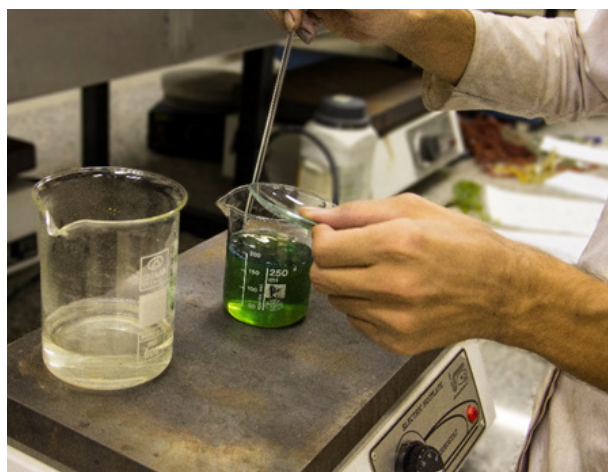
تصویر ۱۶- تغییر رنگ محلول بعد از اضافه کردن هیدروسولفیت (تشکیل لوکوی رنگ)
