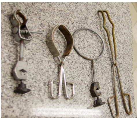
تصویر ۳۱- انواع گیره و پایه‌های نگهدارنده
