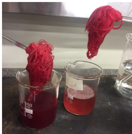
تصویر ۴- نخ پشمی رنگری شده با رنگزای اسیدی لولینگ و سوپرمیلینگ
